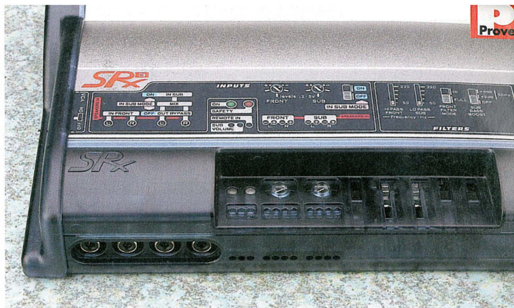
Nel particolare della foto la sezione ingressi ad alto e basso livello con la sezione di controllo del crossover elettronico.
