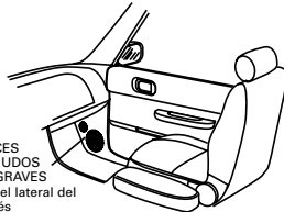
Figura 1. Montaje del altavoz para graves y el altavoz para agudos en el panel lateral del reposapiés
