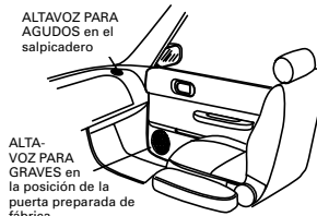
Figura 4. Montaje del altavoz para graves en la puerta y del altavoz para agudos en el salpicadero
