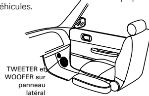
Figure 1. Montage du woofer et du tweeter dans le panneau bas de caisse avant
