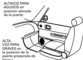
Figura 3. Montaje de altavoces para graves y agudos en las puertas
